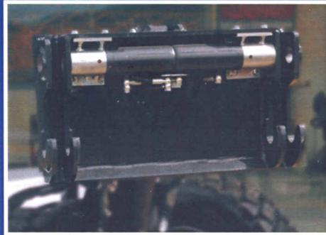
Attache rapide de la bride branchement hydraulique axes supérieurs
