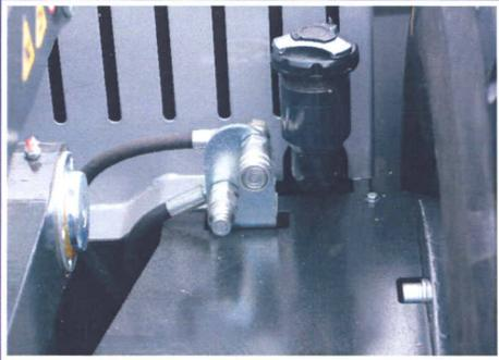
Prise hydraulique auxiliaire avec coupleurs rapides
